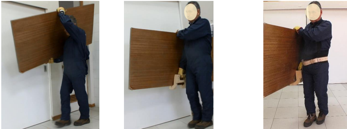
Figura 23. Se ilustran los tres sistemas de transporte estudiados. A la izquierda el manejo de moldajes utilizado en la empresa, en la parte central el uso de mango y a la derecha el uso de mango más soporte sostenido por cinturón
