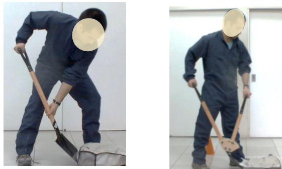
Figura 25. A la izquierda se presenta postura adoptada al emplear pala tradicional y a la derecha al emplear pala que dispone de un segundo mango.
