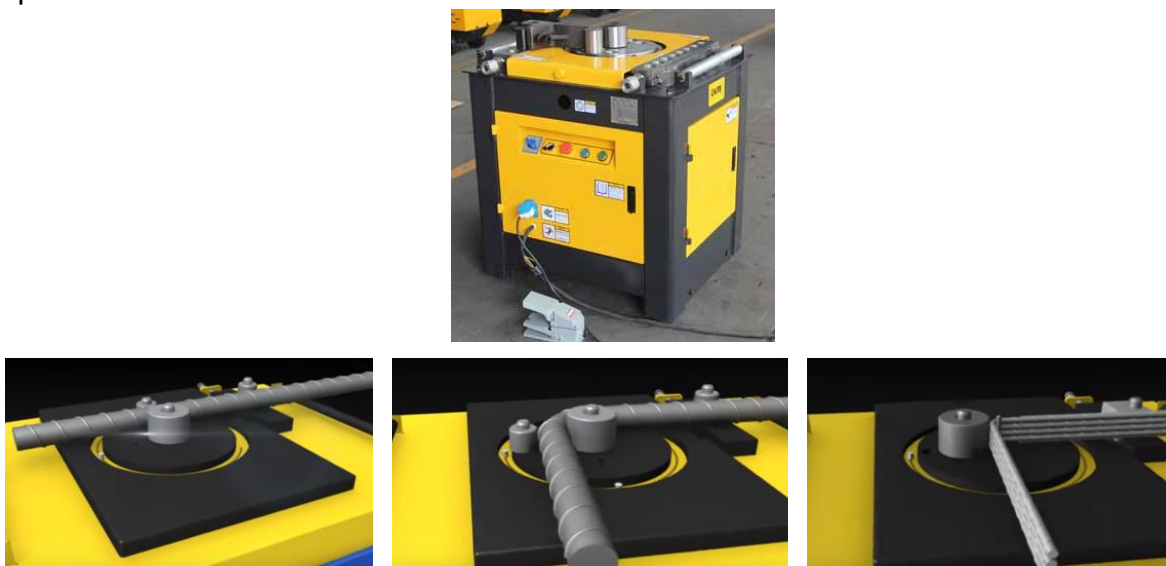
Figura 15. Parte superior: Modelo de dobladora de fierro disponible en el mercado. Parte inferior: Esquemas que ilustran como el giro de la tornamesa dobla uno o más fierros.
