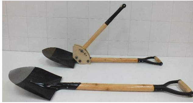
Figura 24. Pala tradicional y rediseño que incorpora un segundo mango.
